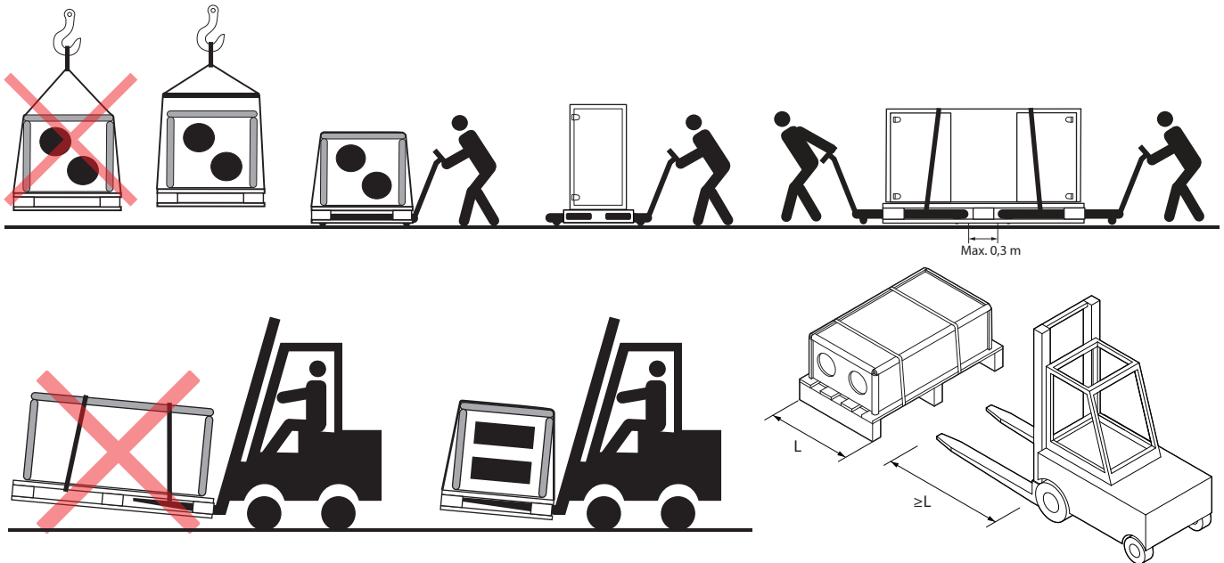
Рис. 5. Примеры транспортировки при помощи крана, автопогрузчика и технологической тележки
