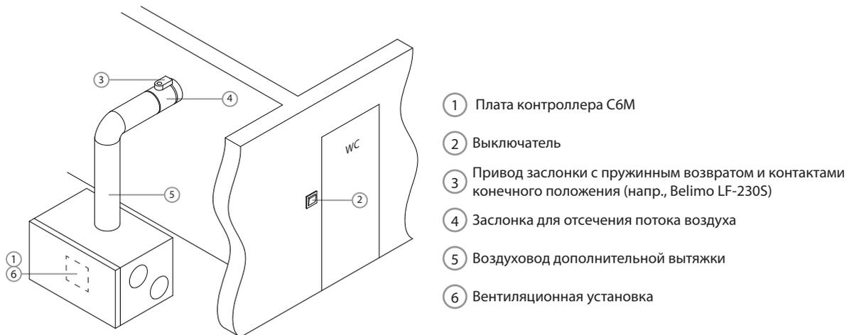
Рис. 9. Пример монтажа воздуховода дополнительной вытяжки воздуха
