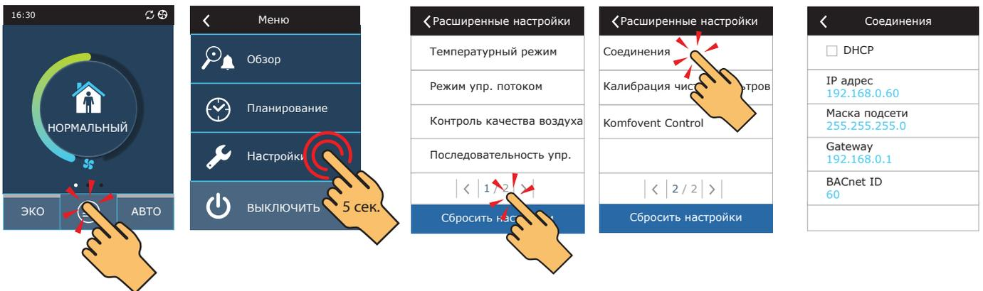
Рис. 18. Просмотр и изменение IP адреса вентиляционной установки в пульте
